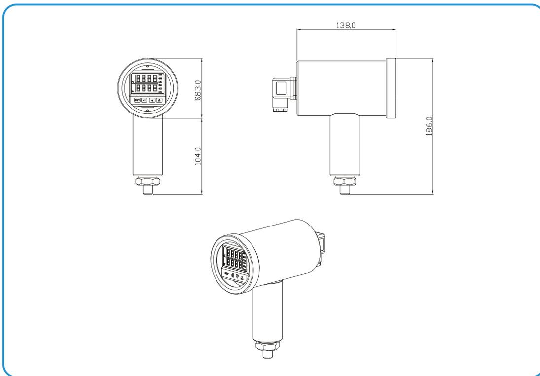
**PRESSOSTATO DIFERENCIAL ELETRÔNICO - TP-PD-AT-EL**
